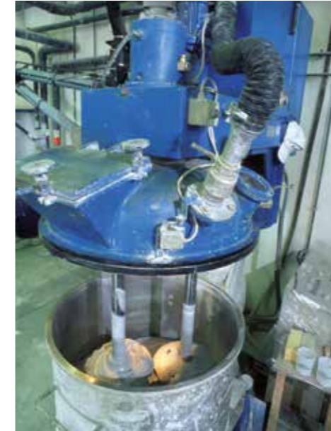
Macchina sottovuoto per il controllo della quantità d'aria presente nello stucco.
